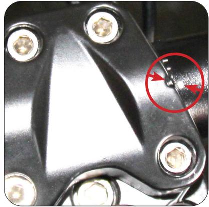
2. Montieren Sie das Griffrohr, verwenden Sie die Schnellspannklemme, um es festzuziehen.
