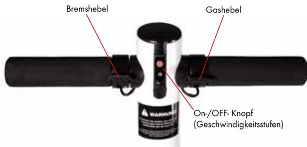
Der SXT Neo kann mit 2 Geschwindigkeitsstufen gefahren werden:
