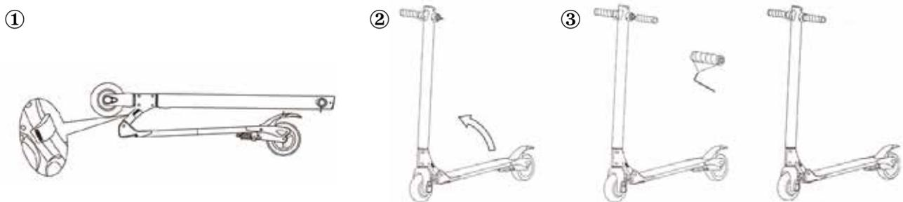
2. Halten Sie die Lenkstange mit der Hand fest und ziehen Sie ihn bis er vertikal zum Boden steht. Ziehen Sie dann bis Sie ein „Klick“ gehört haben. Dies bedeutet, dass der Mechanismus eingerastet ist
